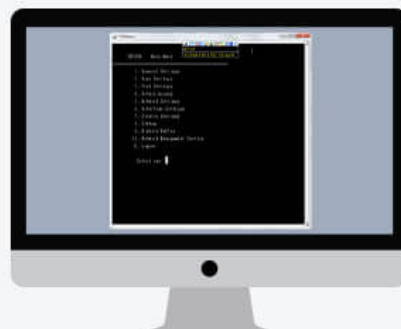
Acesso com base em terminal via consola Telnet/SSH para aplicações de baixa largura de banda
